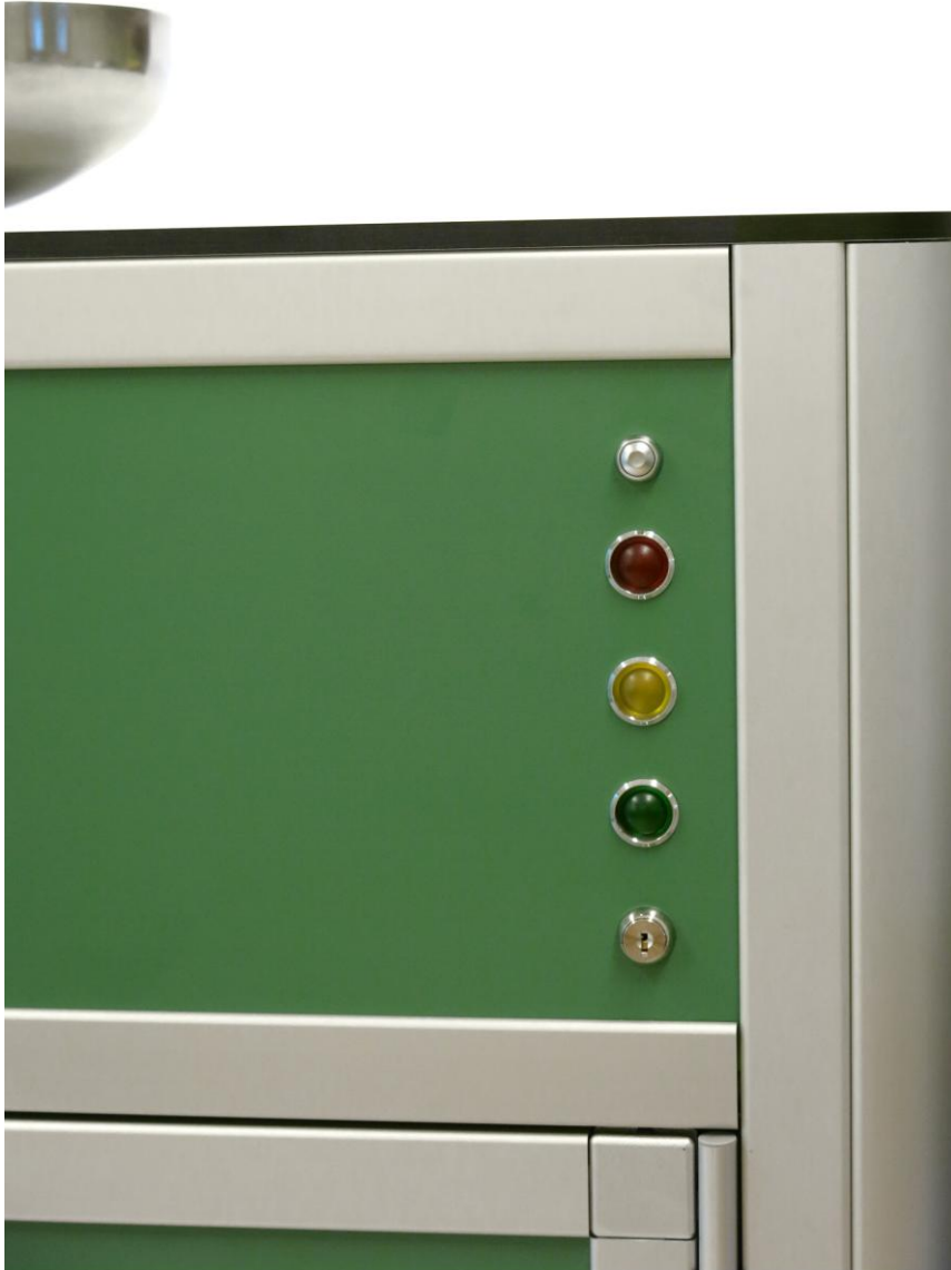
Fig 3. Manöverpanelen på EcoFilter® Modell 101 har utformats för att vara så enkel och användarvänlig som möjligt. Om grön lampa lyser kan urin hällas i tratten. Maskinen aktiveras därefter genom den silverfärgade knappen högst upp. Om röd lampa lyser är maskinen inte redo att användas. Gul lampa indikerar att slaskbehållaren behöver tömmas.
